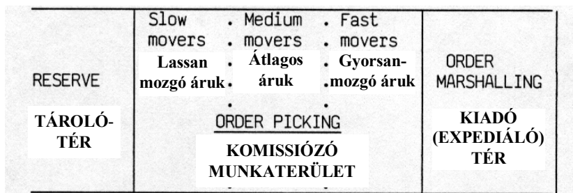
9.7. ábra. A kommissiózó munkaterület kialakítása az áruk forgalmát figyelembe véve
